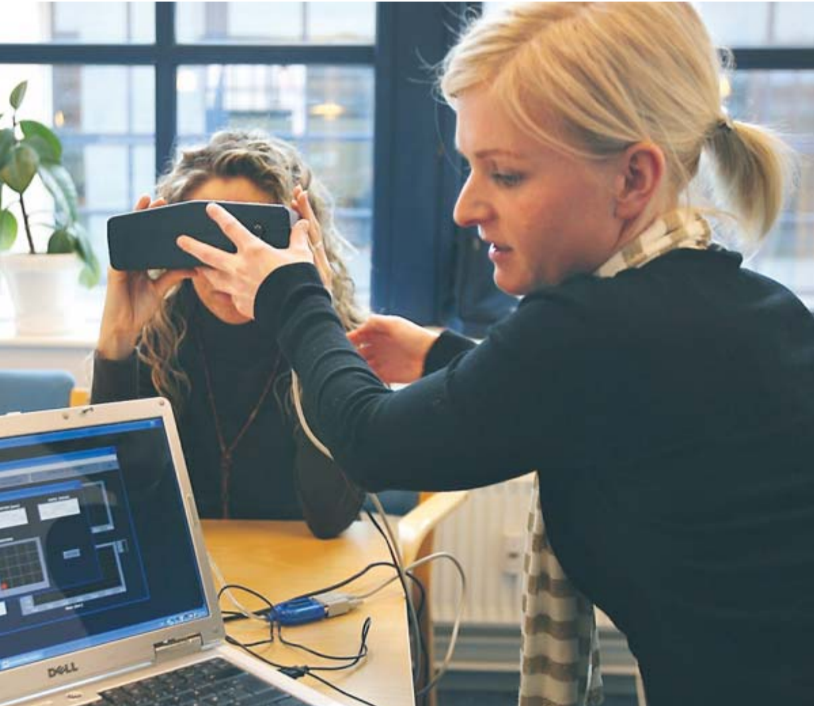
Katja Kofoed (i förgrunden) på Ferleprodukter provar drogtestinstrumentet Eyecheck på sin kollega Kathleen Ungar. Testpersonen håller upp instrumentet framför ögonen och tittar in i det under testet som tar cirka en minut. Kikaren är kopplad till ett program i datorn som ger upplysningar om eventuella substanser av droger eller alkohol i kroppen.
